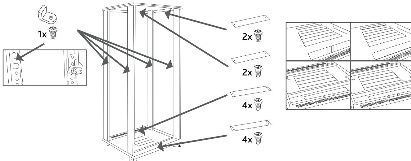
4 - Monte los perfiles horizontales (6) dentro del rack atornillándolos al marco delantero y trasero, y sobre ellos monte perfiles verticales (5) con los tornillos de rosca chapa.
