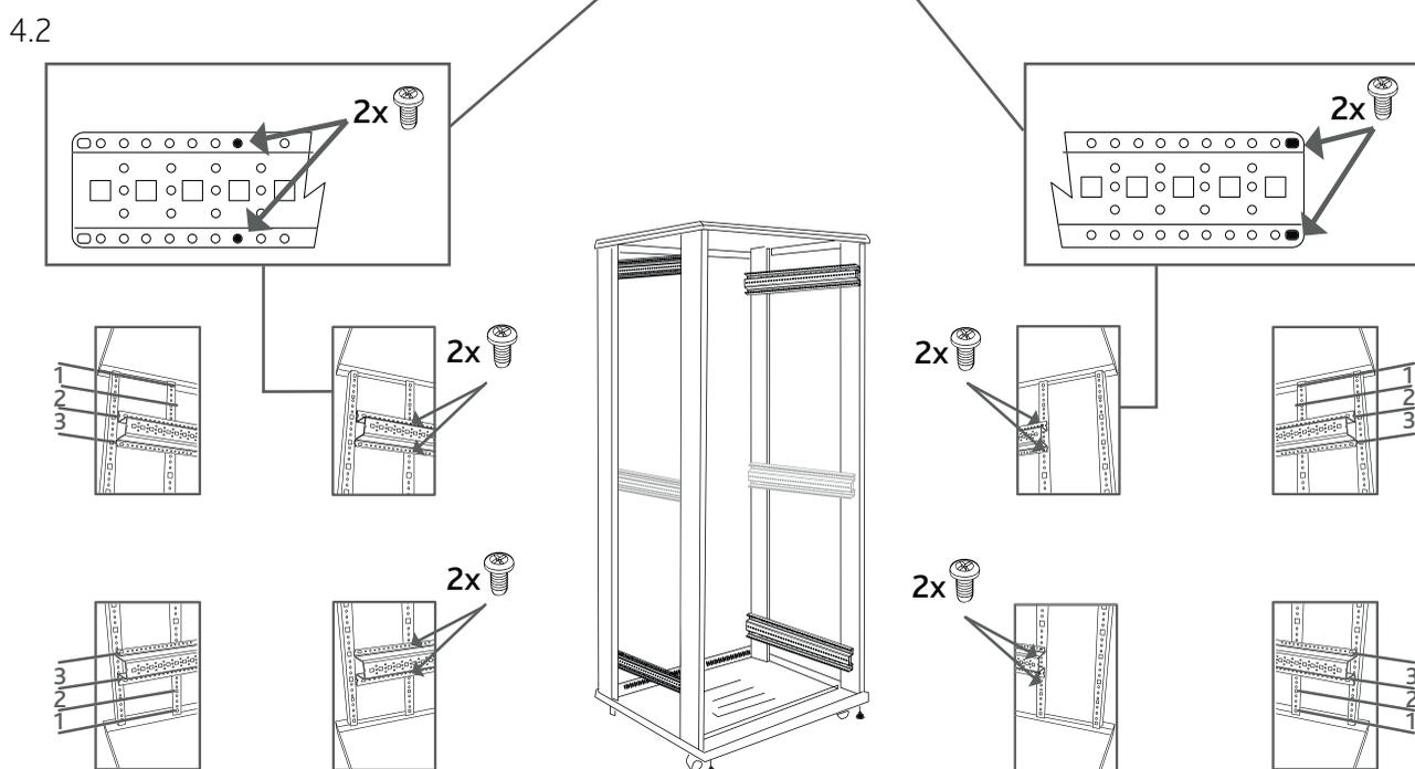
4.3 Atornille los perfiles verticales delanteros a la segunda columna de tres hendiduras redondas de los perfiles horizontales con los tornillos de rosca chapa.
