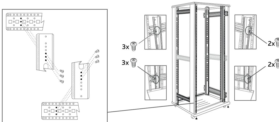
5 – Monte los paneles laterales (3), la puerta delantera (1) y la trasera (2), asegúrese de poner el espaciador (11) en la base de la bisagra
