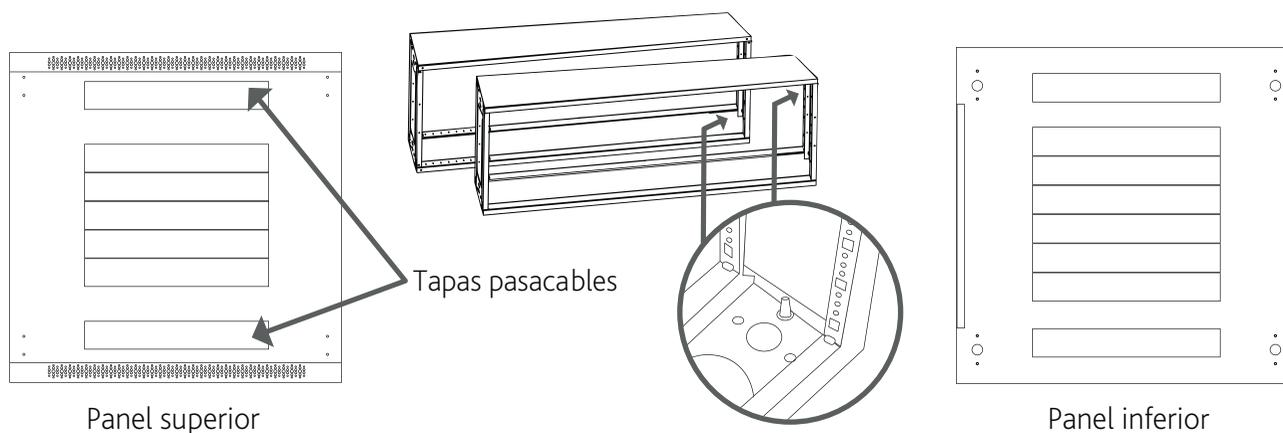
2 - Monte el panel superior e inferior atornillándolos en los dos marcos. Utilice los tornillos M8 y las tuercas M8. Atornille las ruedas (9) con los tornillos de rosca chapa (C) y las patas (D) en el panel inferior.
